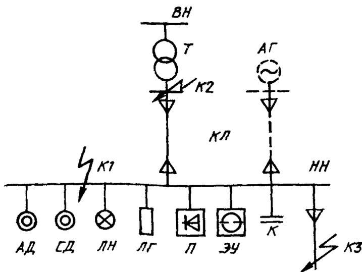
АД — асинхронные двигатели; СД — синхронные двигатели; ЛН — лампы накаливания; ЛГ — лампы газоразрядные; П — преобразователи; ЭУ — электротермические установки; К — конденсаторные батареи; КЛ — кабельная линия; АГ — автономный источник электроэнергии; К1, К2, К3 — точка КЗ; Т — трансформатор
